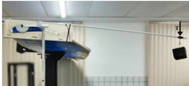
Figura 5. Ensaio de rigidez torcional. (Autoria própria)
