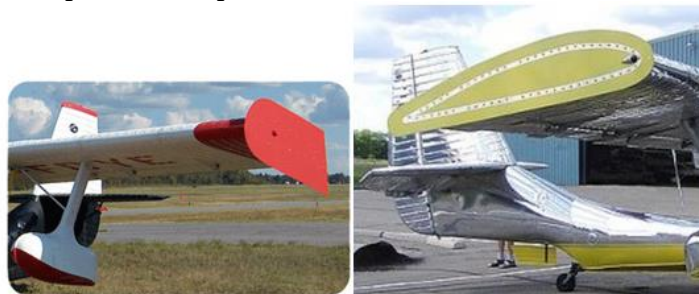
Figura 5 - Exemplos de end plates utilizados em aeronaves comerciais
