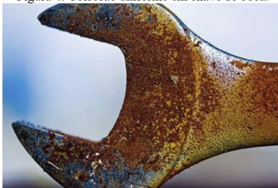
Figura 4: Corrosão uniforme em chave de boca.
