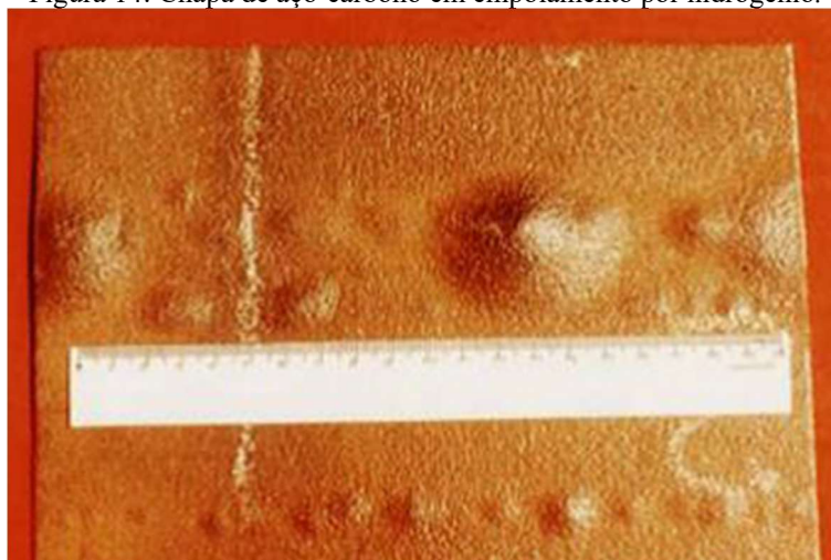
Figura 14: Chapa de aço-carbono em empolamento por hidrogênio.
