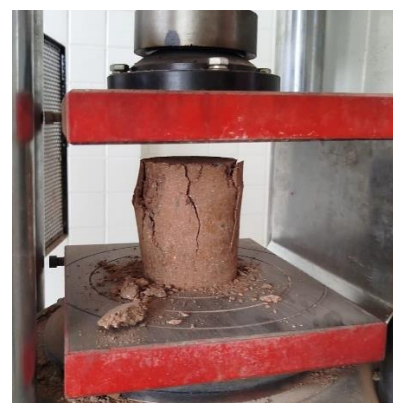
solo – RCD 20%. 2% abaixo da umidade ótima (18,07%)
