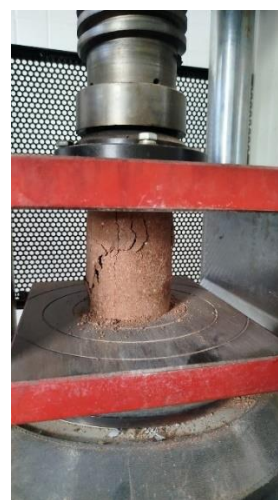
Solo – Cimento 2% abaixo da umidade ótima (11,75%)
