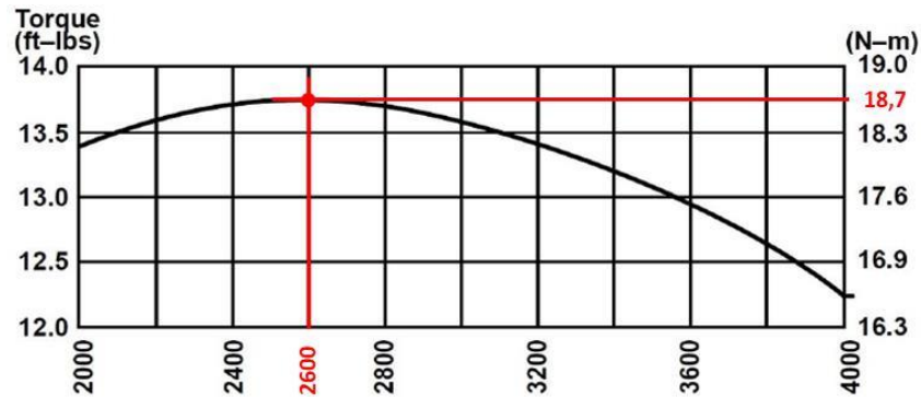
Figura 12 - Gráfico torque x rotação do motor Briggs & Stratton Intek Pro® 10 hp
