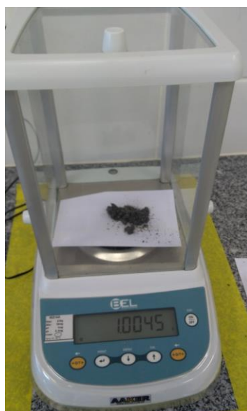
Figura 5. Pesagem do material para análise do teor de cinza. FONTE: O autor (2018).
