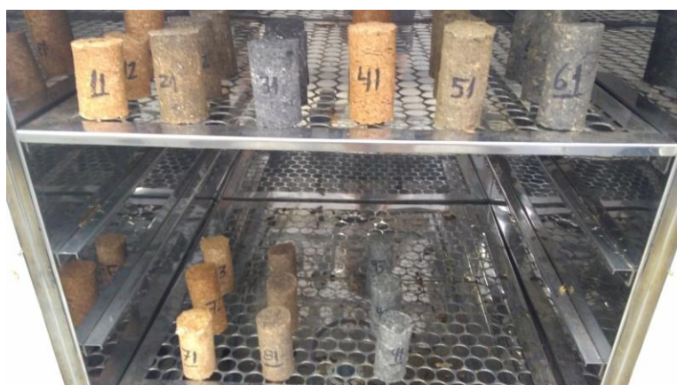
Figura 3. Processo de determinação de teor de umidade. FONTE: O autor (2018).
