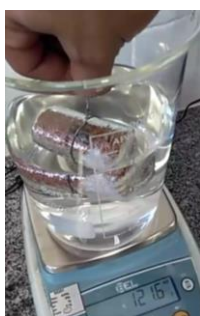
Figura 6. Determinação de volume pelo princípio de Arquimedes FONTE: O autor (2018).
