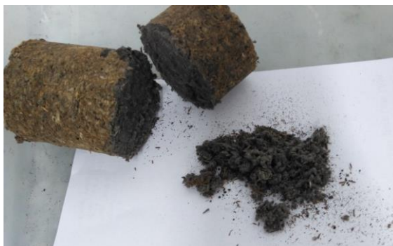
Figura 4. Briquete moído para determinação do teor de cinza. FONTE: O autor (2018)
