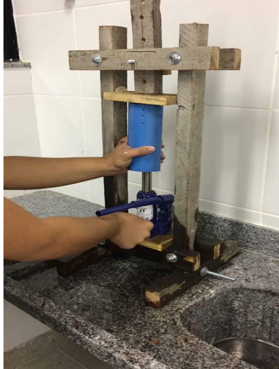
Figura 2. Prensa de Peterson adaptada. FONTE: O autor (2018)
