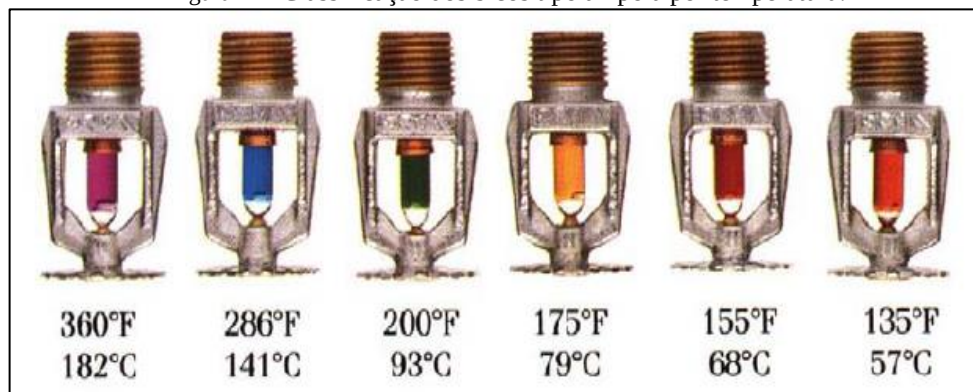
Figura 12 - Classificação dos bicos tipo ampola por temperatura.
