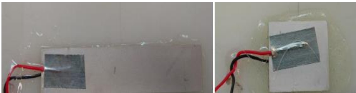
Figura 27: PVDF à esquerda e PZT à direita
