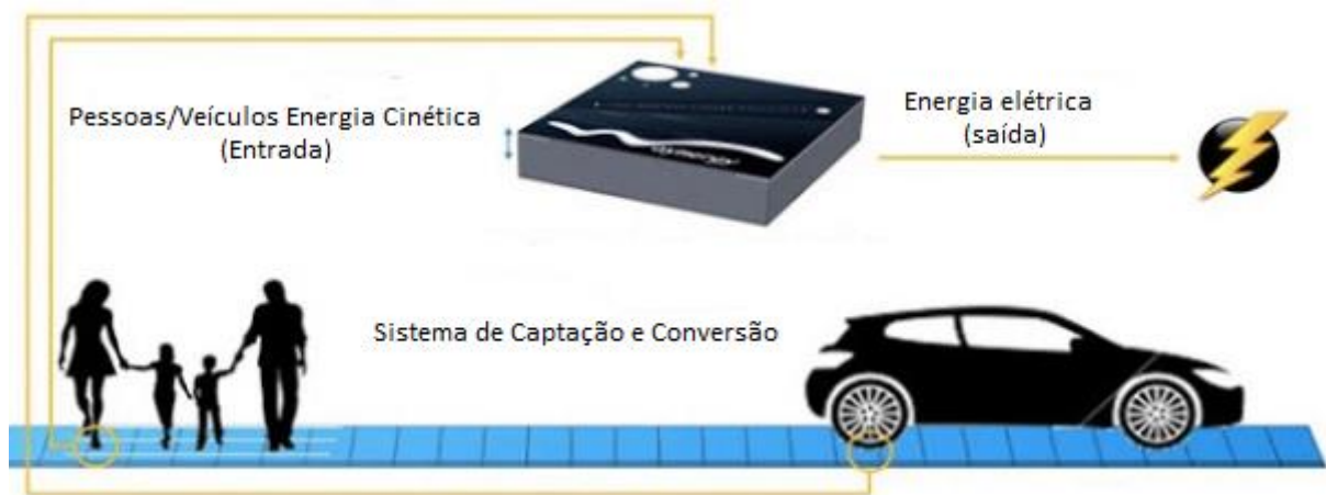
Figura 25: Esquema da produção elétrica em rodovias pelo efeito piezoelétrico
