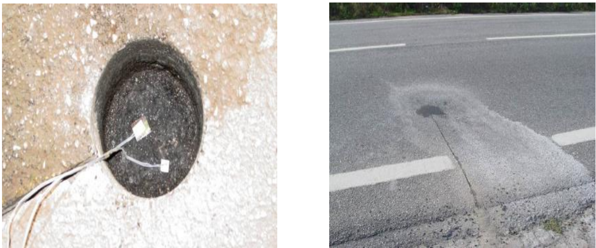
Figure 33: Furo com materiais piezoelétricos nas três profundidades
