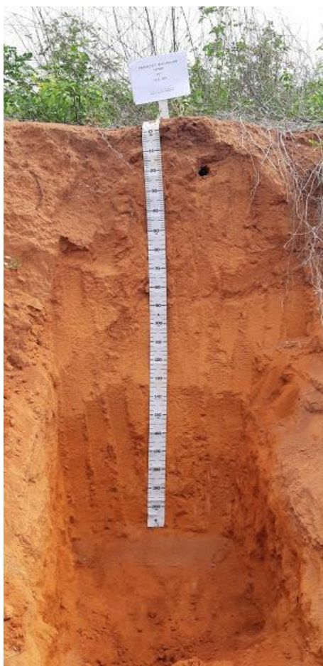
Perfil de LATOSSOLO VERMELHO-AMARELO Eutrófico argissólico, coletado no município de Açu - RN, em 31 de janeiro de 2020.
