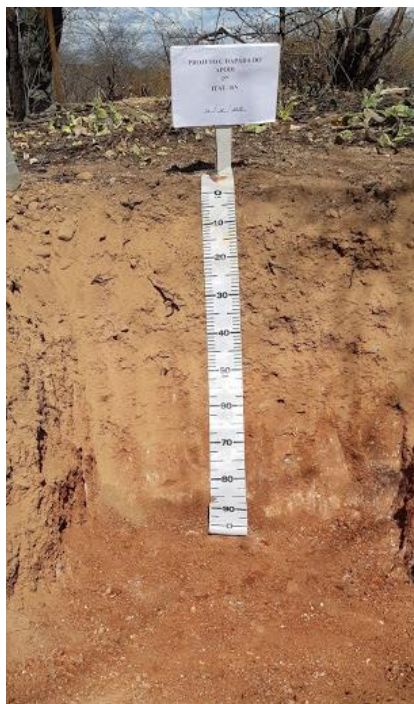
Perfil de LUVISSOLO CRÔMICO Ótico típico e imagem da vegetação, coletado no município de Apodi- RN, em 16 de dezembro de 2019.
