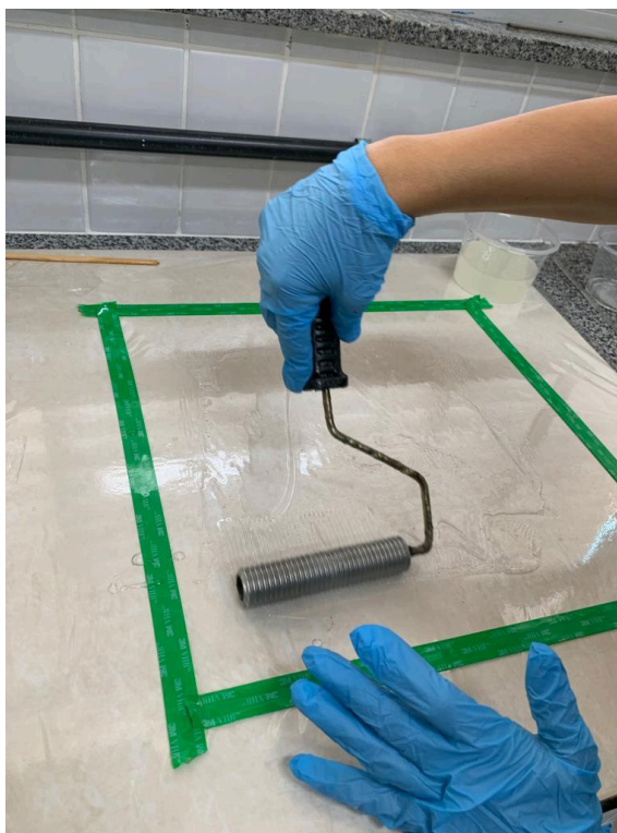
Figura 10: Aplicação da resina no plástico transparente.
