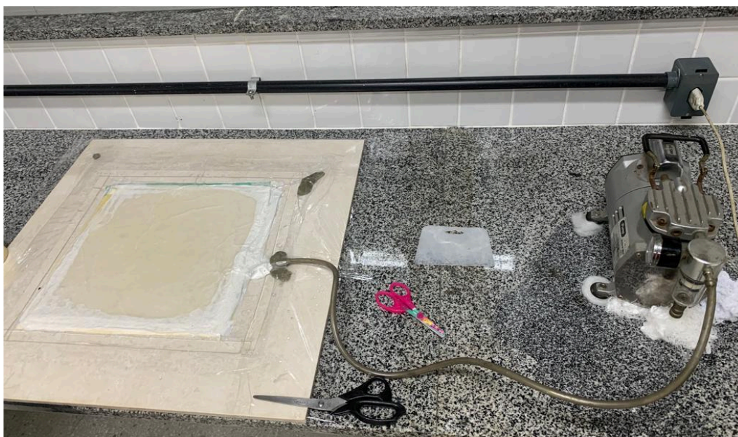
Figura 12: Processo de laminação Vacuum Bagging.
