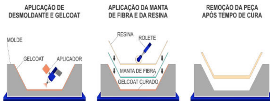
Figura 6: Processo de laminação Hand Lay-Up.
