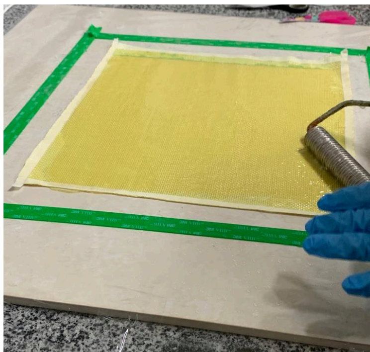
Figura 11: Adição das camadas de tecido de aramida.
