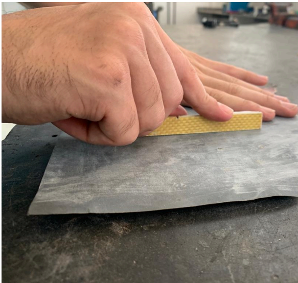
Figura 14: Processo de lixamento dos corpos de prova.
