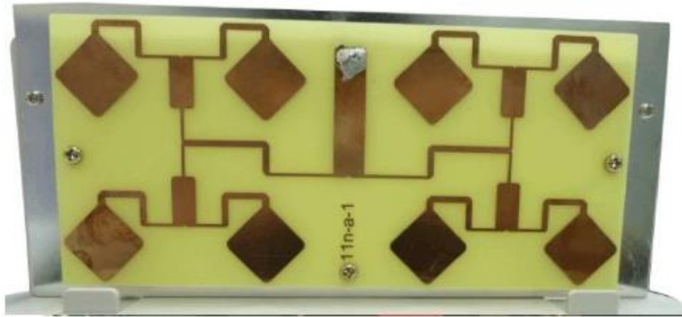
Figura 8 – Arranjo de uma antena de microfitas, aplicada em WLAN para 5.8 GHz.
