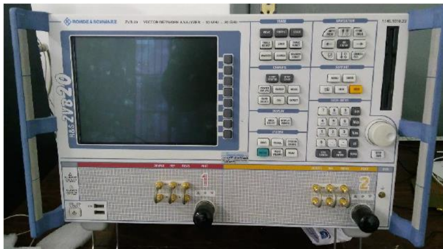
Figura 37 – Analisador de Redes Vetoriais.
