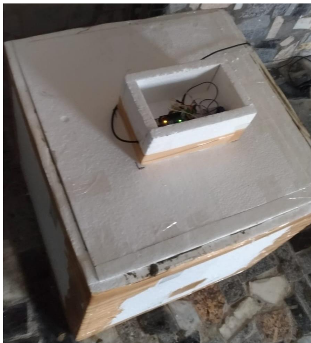
Figura 23 - Monitoração da temperatura dentro da fôrma
