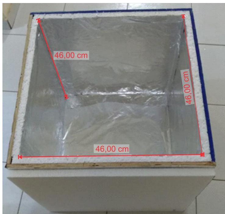
Figura 20 - Fôrma para concretagem com revestimento final
