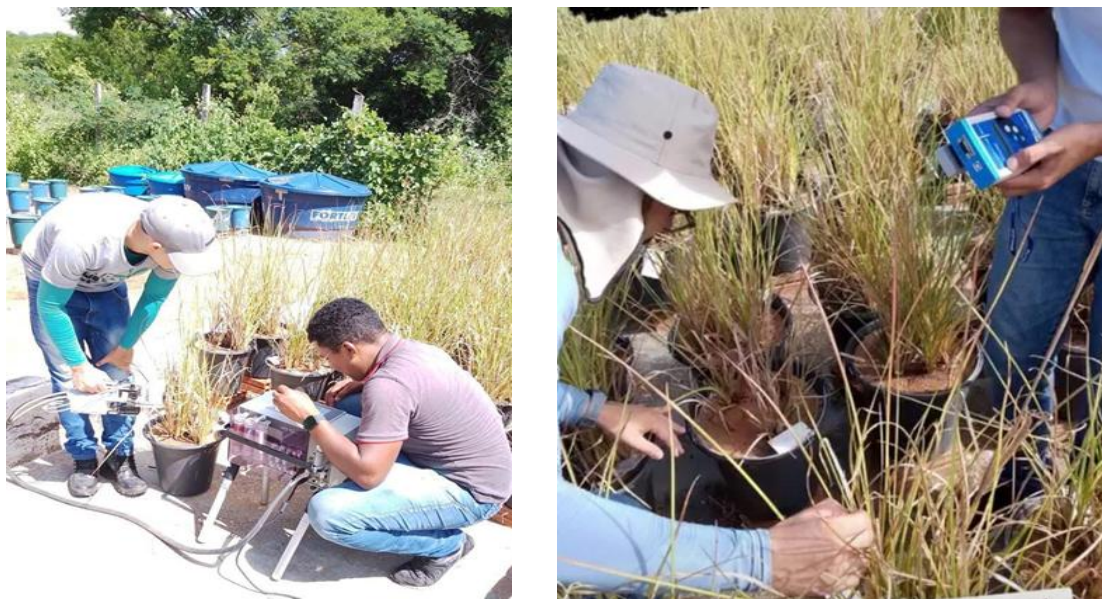
Figura 4. Imagens das medições fisiológicas com analisador portátil de gás carbônico por infravermelho (A) e medidor eletrônico de clorofila (B). Fonte: O autor (2026).
