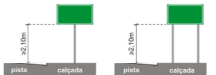
Figura 3 – Altura mínima para placa de indicação
