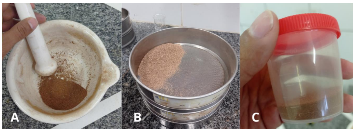
Figura 1 – A) Maceração, B) peneiração e C) resultado da madeira do Sabiá.
