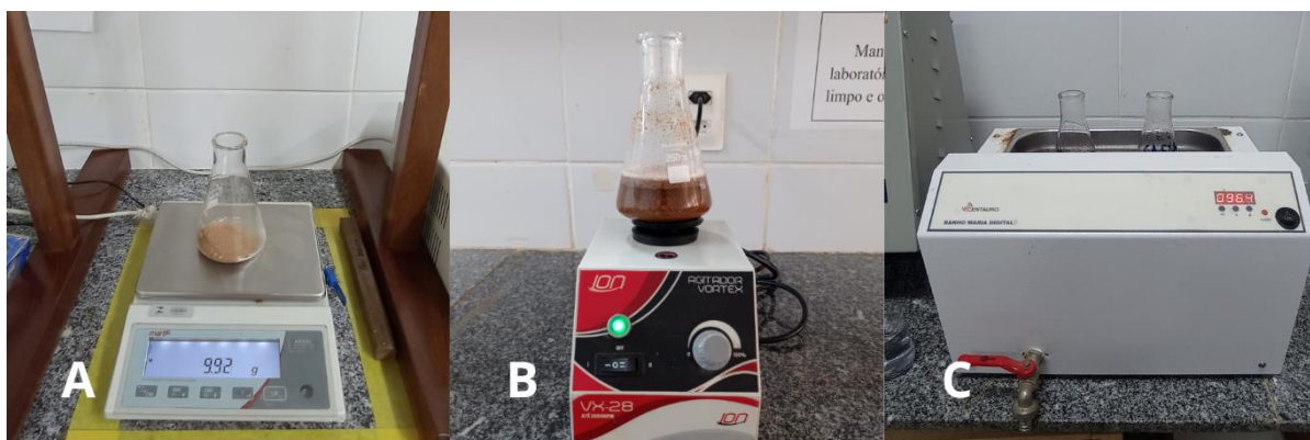
Figura 2 – Extração a quente da espécie sabiá: A) pesagem, B) homogeneização e C) processo de banho maria da espécie do sabiá.
