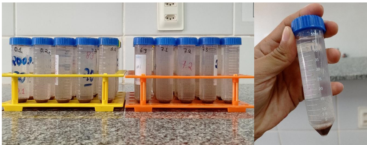
Figura 2: Solução de NaCl 0,01 \text{ mol}\cdot\text{L}^{-1} nos tubos falcon em diferentes faixas de pH (0, 1, 2, 3, 4, 5, 6, 7, 8, 9, 10, 11 e 12) após a finalização do tempo de agitação.
