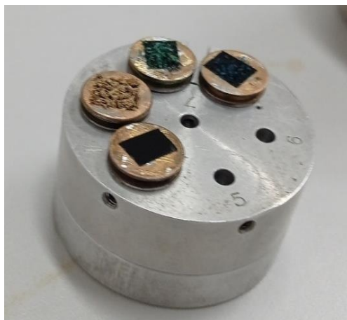
Figura 1: Suporte das amostras para a análise de microscopia eletrônica de varredura
