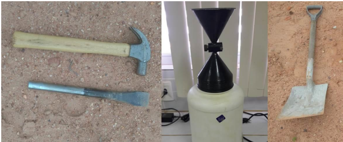
Figura 10 - Da esquerda para a direita: (i) Martelo e Talhadeira; (ii) Conjunto Frasco+Funil; (iii) Pá.
