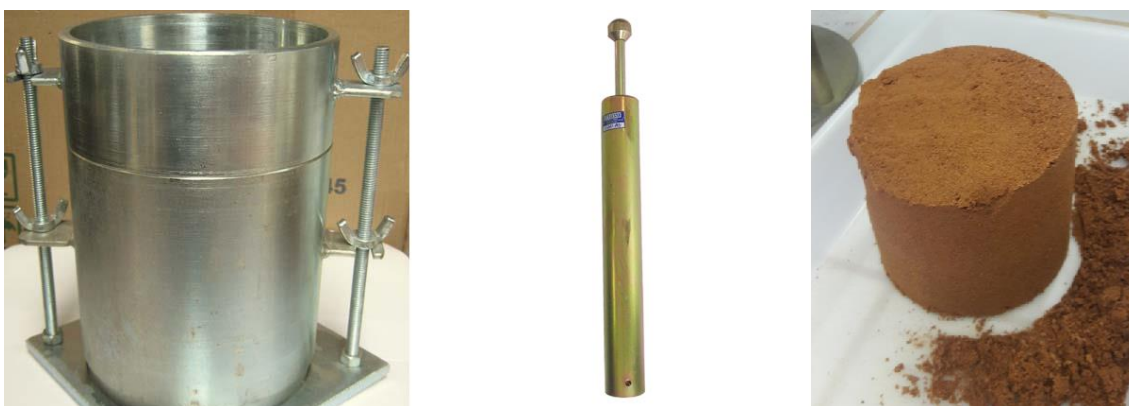
Figura 13 - Da esquerda para a direita: (i) Molde cilíndrico; (ii) Soquete cilíndrico; (iii) Molde executado.
