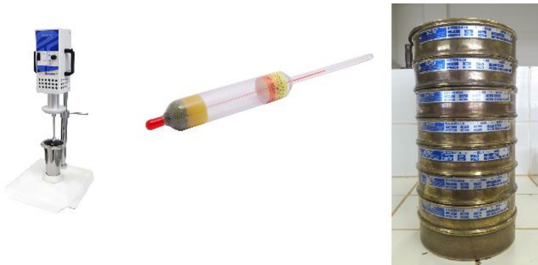
Figura 9 – Da esquerda para a direita: (i) Dispensor de amostras; (ii) Densímetro padrão; e (iii) Série normal de peneiras a ser utilizada no ensaio de peneiramento.
