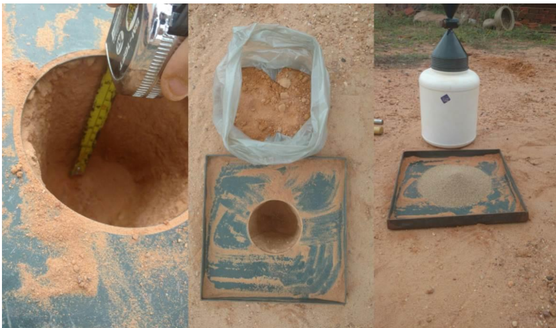
Figura 11 – Da esquerda para a direita: (i) abertura da cavidade; (ii) retirada do material da cavidade; (iii) execução do ensaio na cavidade.
