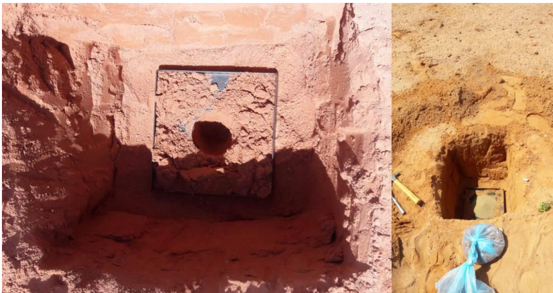
Figura 12 - Da esquerda para a direita: (i) abertura da cavidade na vala de 50 cm de profundidade; (ii) execução do ensaio na cavidade e retirada do material.
