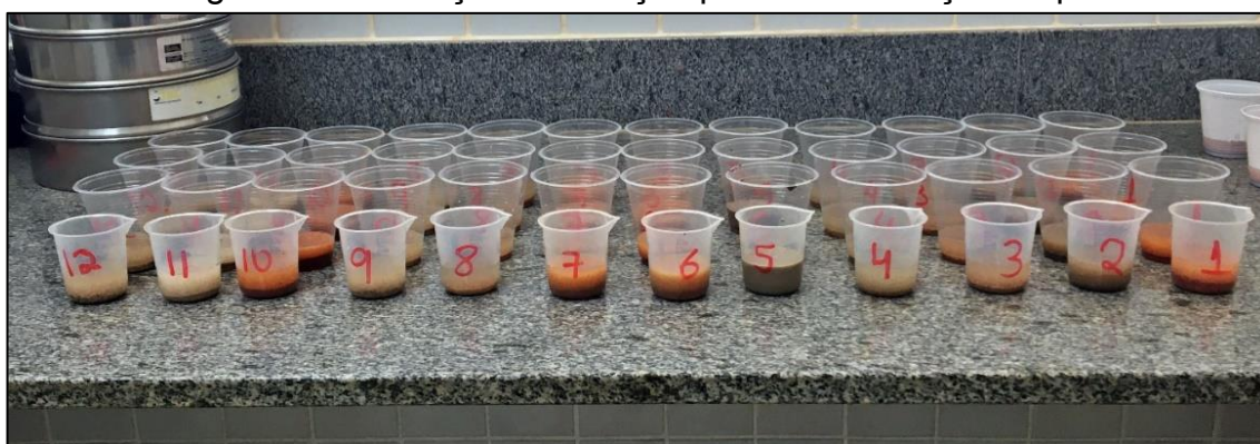
Figura 15 – Extração da solução para determinação de pH
