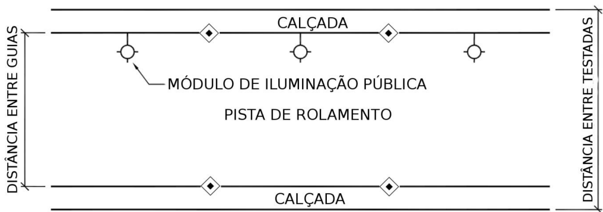
Figura 15 - Posicionamento Unilateral Utilizando o Sistema de Detecção
