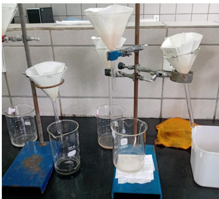
Figura 3- Suporte para etapa de filtração- separação da água dos filmes analisados na solubilidade.
