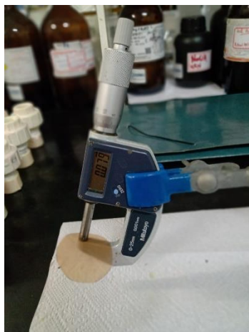
Figura 2-Micrômetro digital medindo a espessura dos filmes caracterizados.
