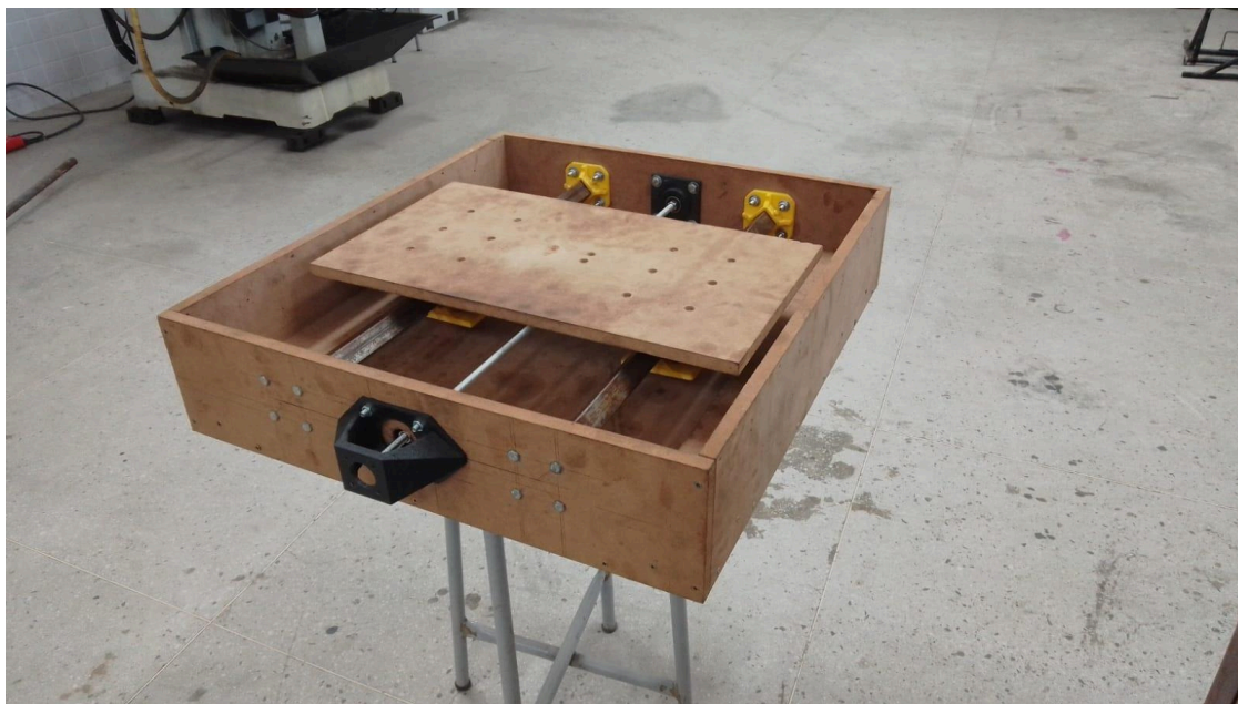
Figura 30 - Montagem da base e eixo Y
