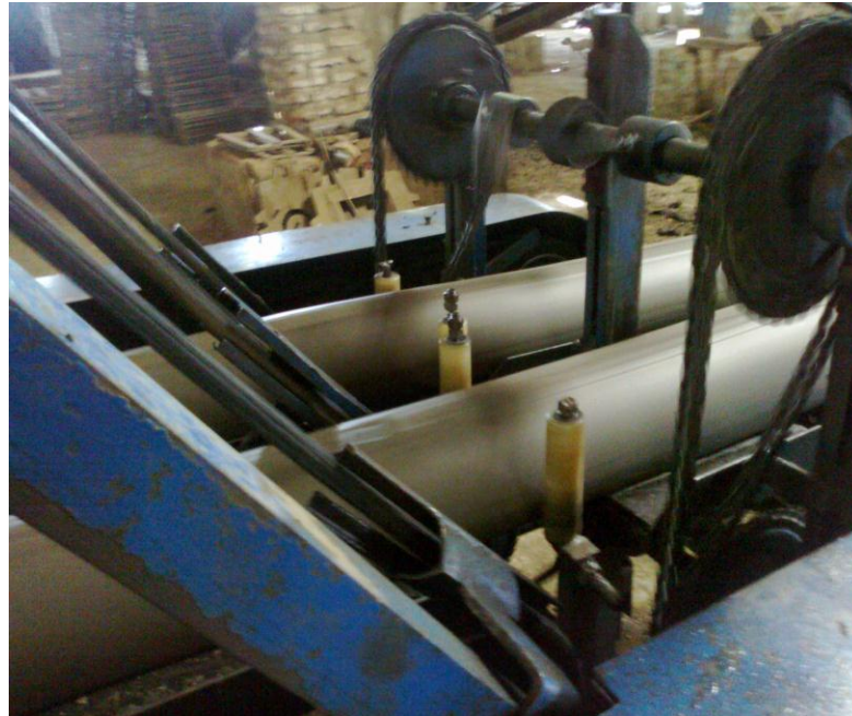
Figura 26 - A coluna de telha recebendo o corte e o acabamento
