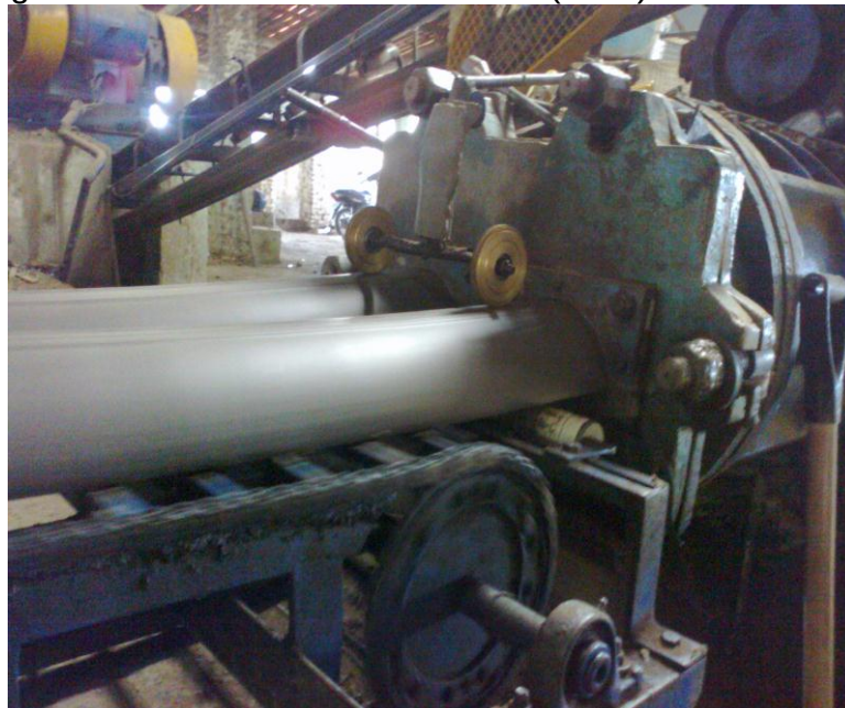
Figura 25 - A argila sendo conformada em coluna (telha) e carimbada
