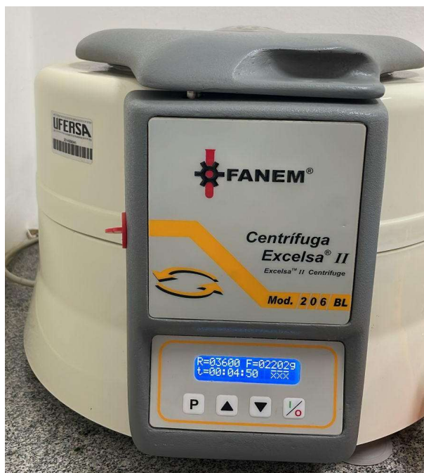
Figura 5 - Centrífuga mod 206 Bl Excelsa II Fanem, utilizada para realizar separações das soluções.
