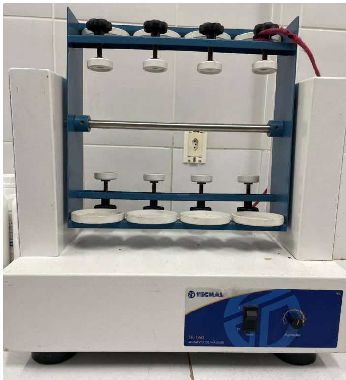
Figura 10 - Agitador de Wagner, utilizado para realizar a mistura dos polímeros com as soluções com corante.
