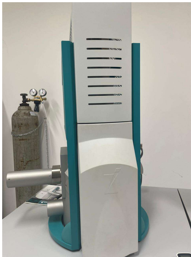
Figura 7 - Microscópio Eletrônico de Varredura, utilizado para obter a morfologia da superfície da amostra.
