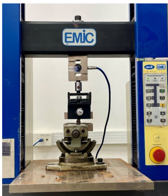
Figura 7. Máquina eletromecânica de ensaios universais (EMIC DL 1000), com Bloco-Enxerto-Parafusos acoplados à mesma, pronta para realizar o ensaio (autoria própria).
