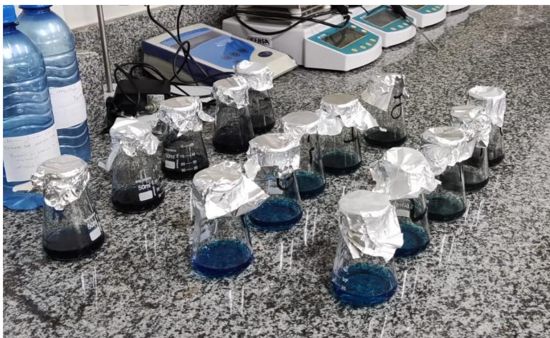
Figura 10 - Béqueres com a solução azul de metileno e carvão.
