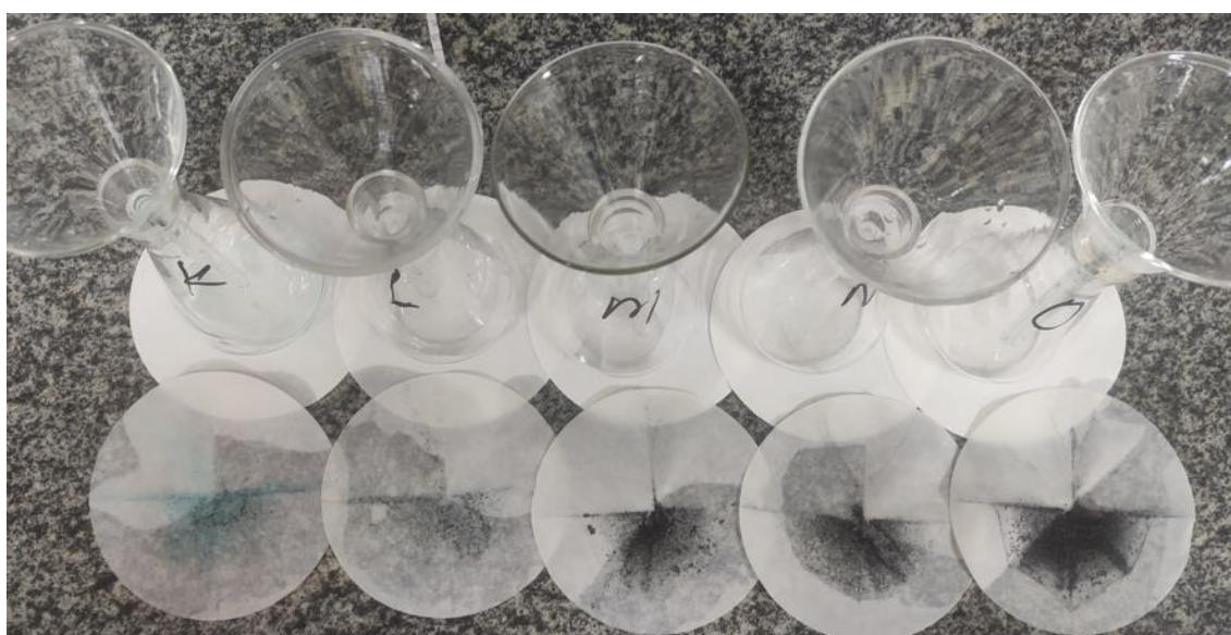
Figura 13 - Resultado após filtragem do carvão ativado de coco babaçu.
