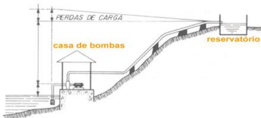
Figura 1: Exemplificação de uma EE de água.
