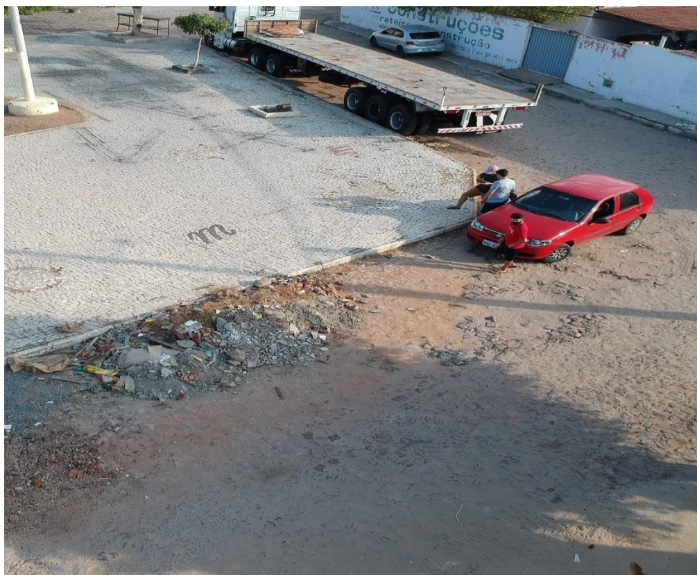
Figura 19: RCC disposto em lugar inadequado ao lado da Rua Adauto Leite na cidade de Mauriti - CE
