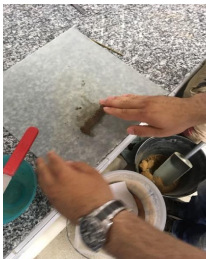
Figura 38- Verificação da plasticidade do solo.
