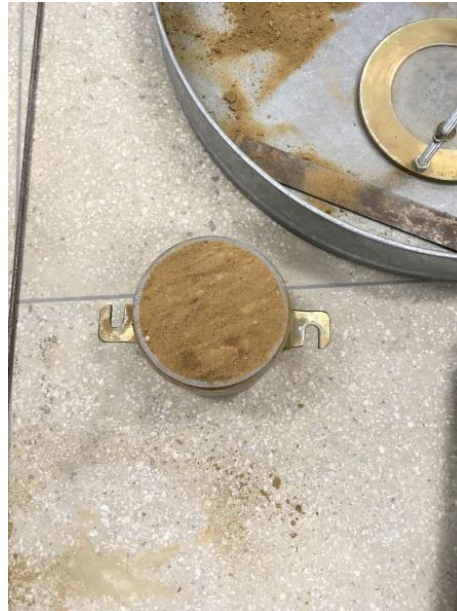
Figura 28- Ensaio de Compactação.
