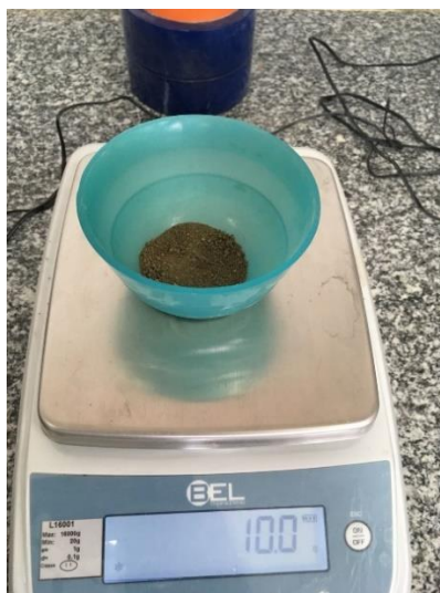
Figura 22- Materiais utilizados para averificação da plasticidade do solo.
