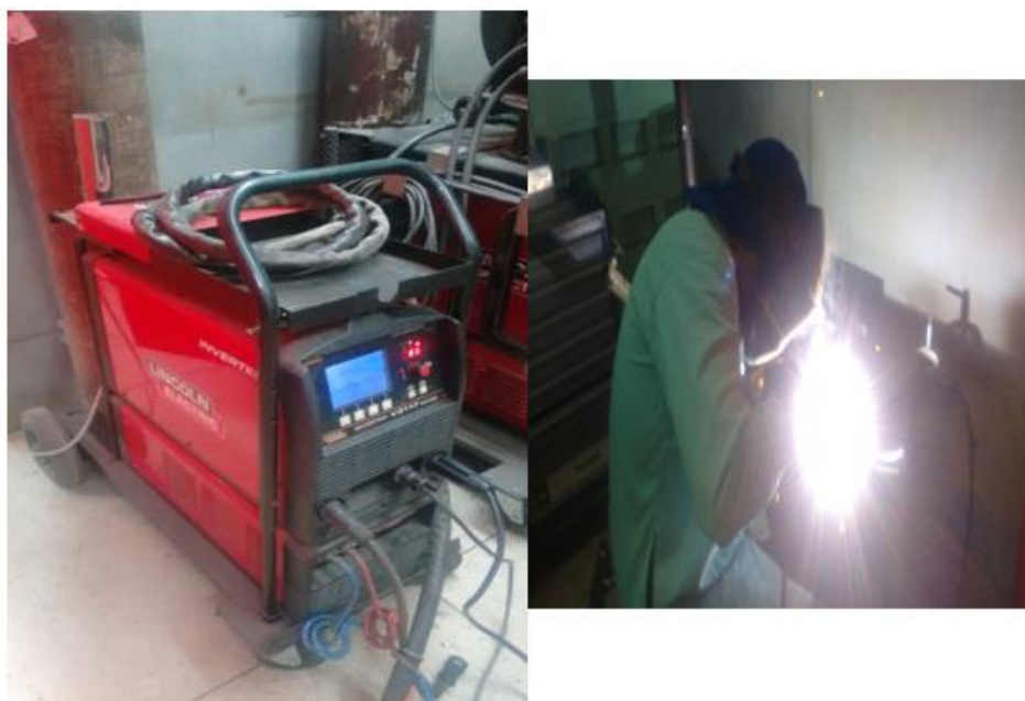
Figura 10: a) Fonte de energia; b) Soldagem das juntas de topo
