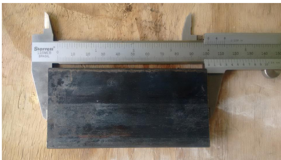
Figura 7: Barra de aço A-36
