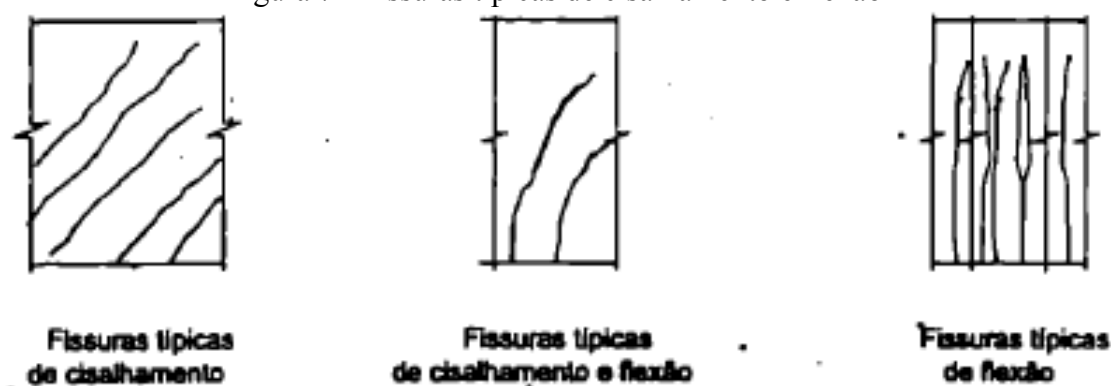
Figura 7 - Fissuras típicas de cisalhamento e flexão
