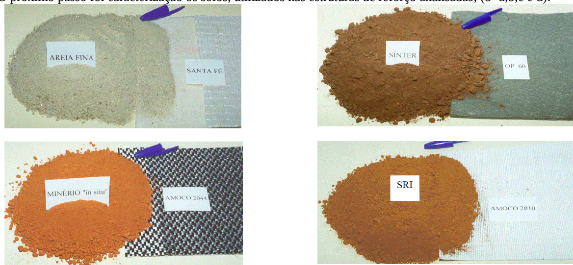
Figura 5 – a) Obra 1: Amostras da areia fina micácea e do geotêxtil não tecido Santa Fé, b) Obra 2: Amostras do síter e do geotêxtil não tecido OP 60, c) Obra 2: Amostras do minério “in situ” e do geotêxtil tecido Amoco 2044, d) Amostras do solo residual de itabirito (SRI) e do geotêxtil tecido Amoco 2010 (Martin, 2000).
