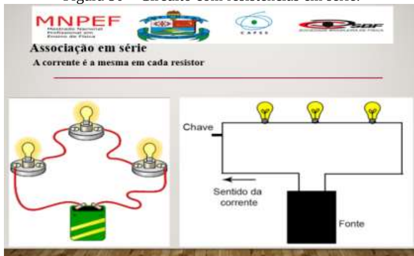
Figura 50 – Circuito com resistências em série.
