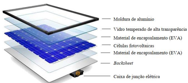
Figura 4: Constituição de um módulo fotovoltaico.
