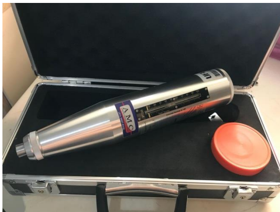
Figura 7 - Esclerômetro convencional AMC
