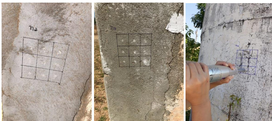
Figura 20 - Aplicação do esclerômetro
