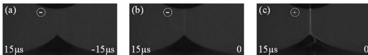
Figura 18. Deformação na superfície de solução aquosa submetida a uma descarga de plasma atmosférico a) momento anterior ao brilho, b) após 15 \mu s com eletrodo metálico catódico e c) anódico.
