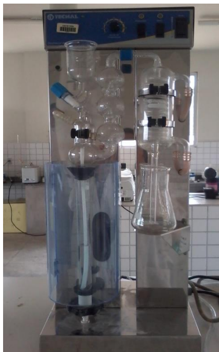
Figura 8 – Destilador de nitrogênio, com Erlenmeyer e tubo digestor acoplado, utilizado no experimento de determinação de proteínas totais.
