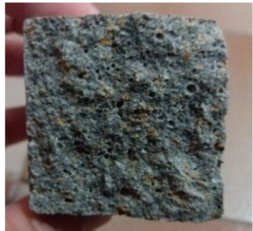
Figura 31 – Corpo de Prova P10% – (A) Ruptura do CP; (B) Seção do CP.
