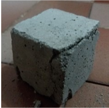
Figura 30 – Corpo de Prova PR – (A) Ruptura do CP; (B) Seção do CP.
