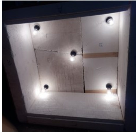
Figura 44 – Instalação das lâmpadas incandescentes no fundo da câmara térmica.
