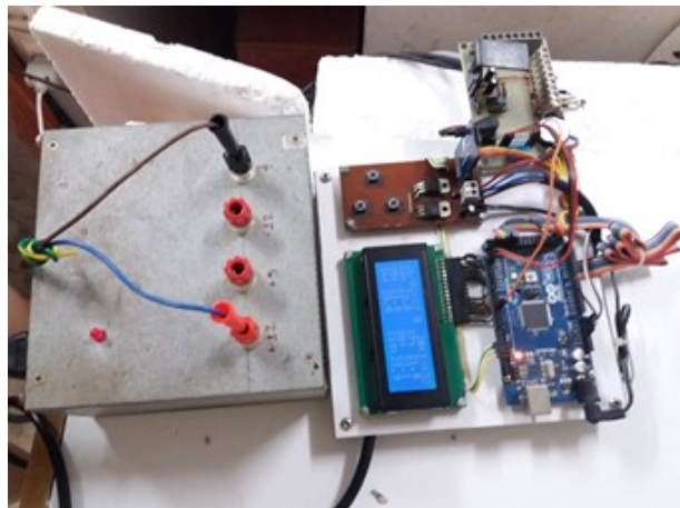
Figura 46 – Sistema de aquisição de dados térmicos.
