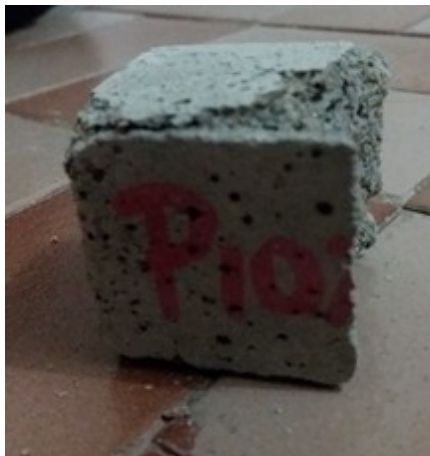
Figura 31 – Corpo de Prova P10% – (A) Ruptura do CP; (B) Seção do CP.
