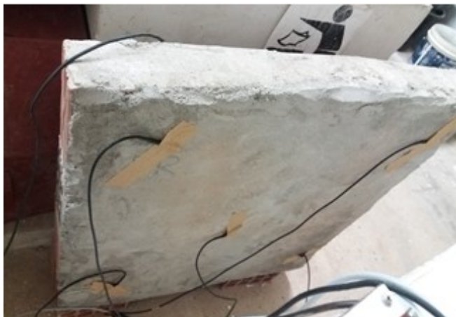
Figura 47 – Fixação de sensores sobre a placa com fita crepe.
