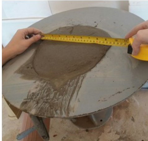
Figura 20 – Realização de ensaio em mesa de consistência por queda – PR.
