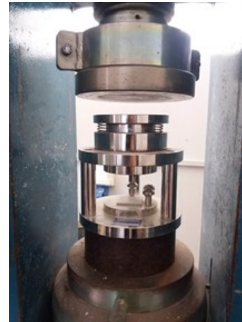
Figura 29 – Acessório para determinação de resistência a compressão na prensa.
