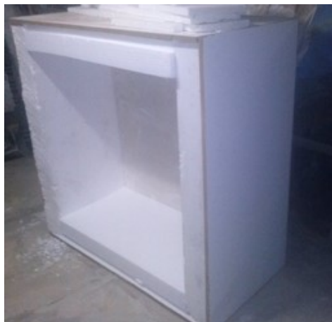
Figura 43 – Câmara térmica com revestimento em EPS.
