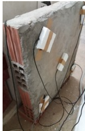
Figura 48 – Colocação de placas de EPS sobre os sensores.
