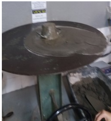
Figura 22 – Realização de ensaio em mesa de consistência para determinação de relação água/cimento das argamassas com adição.
