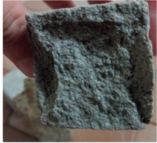
Figura 30 – Corpo de Prova PR – (A) Ruptura do CP; (B) Seção do CP.
