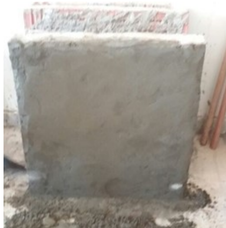
Figura 41 – Placa de argamassa padrão com acabamento final.
