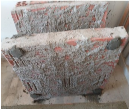
Figura 39 – Placa de alvenaria com mestras para aplicação de camada única.
