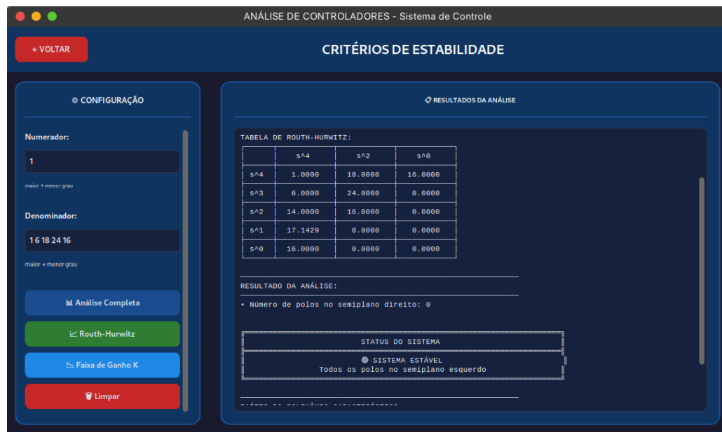
Figura 21 – Análise do polinômio estável D(s) = s^4 + 6s^3 + 18s^2 + 24s + 16 (Exemplo 3.13-c de Castrucci). Saída obtida pela ferramenta
