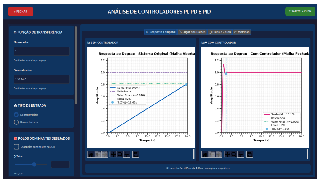
Figura 33 – Resposta ao degrau comparativa. Nota: O gráfico à esquerda ('Sem Controlador') exibe a dinâmica natural da planta com ganho unitário ( K = 1 ), resultando em uma resposta lenta. O gráfico à direita ('Com Controlador') demonstra a eficácia do PD aplicado, acelerando a resposta
