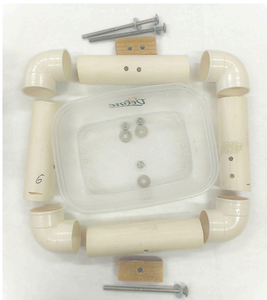
Figura 15: Suporte para o “cérebro” do robô
