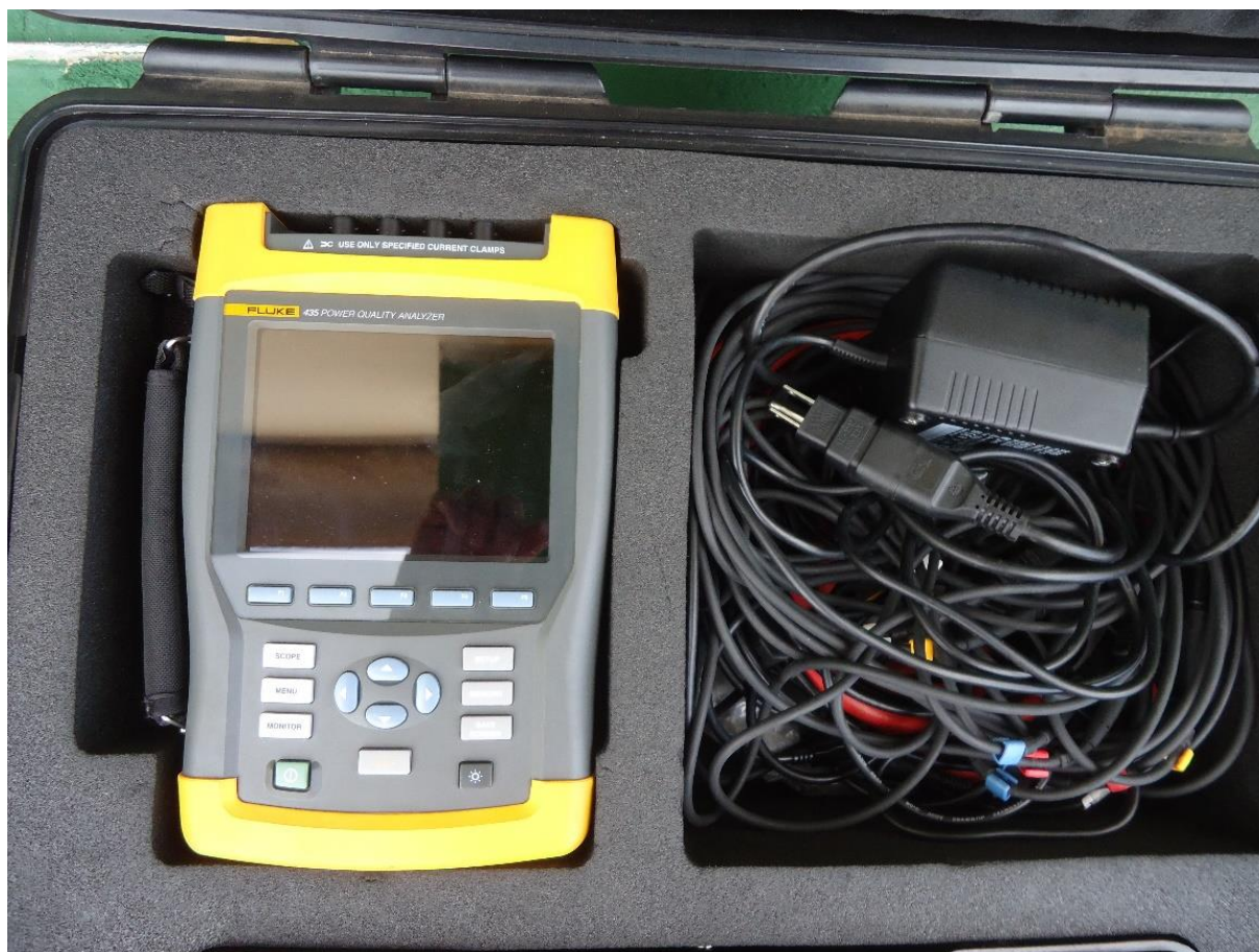
Figura 24 – Analisador de energia Fluke 435.
