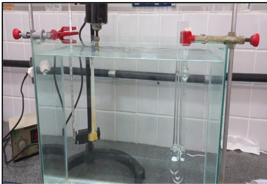
Figura 7 - Procedimento montado para realização do mecanismo de viscosimetria capilar (banho termostático)
