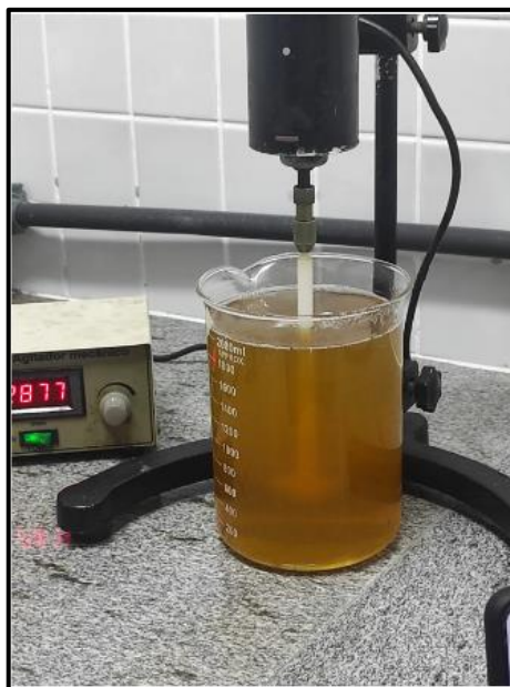
Figura 4 - Agitação mecânica da solução aquosa de ácido acético e quitosana.
