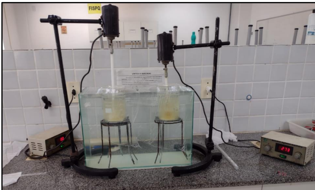
Figura 10 - Agitação da mistura de cloridrato de tetraciclina e quitosana, após 24 horas de intumescimento.
