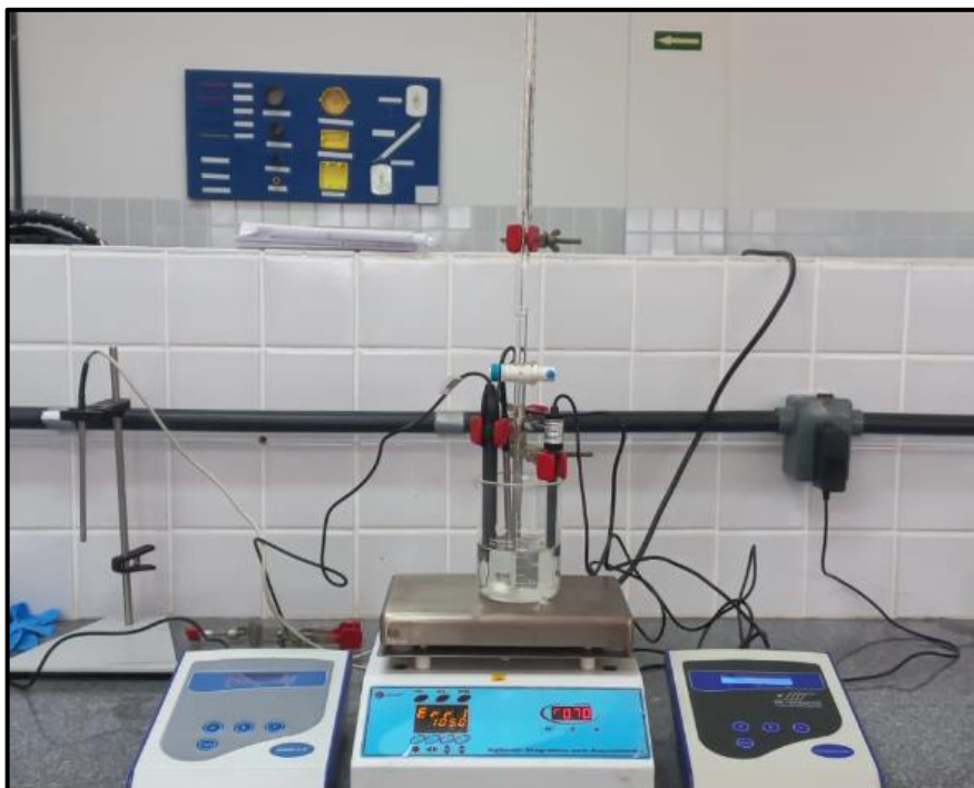
Figura 9 - Procedimento montado para realização da titulação condutimétrica.
