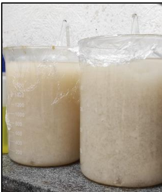
Figura 5 - Precipitação da quitosana após inserir a solução de hidróxido de sódio
