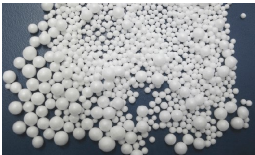
Figura 10 – EPS em seu modelo primário de obtenção
