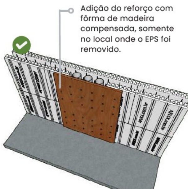
Figura 19 – Instalação hidrossanitária com reforço de fôrma.
